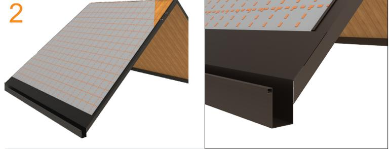
Para continuar se debe hacer la instalación de la canal de agua lluvia en los aleros correspondientes, ya que el proceso de instalación del producto es de abajo hacia arriba y la trama parte cubriendo el espacio que utiliza la canal o el forro correspondiente.
