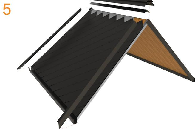
Una vez ya finalizado el proceso de montaje de los módulos, se procede a sellar en sus Aristas para evitar filtración en uniones.
