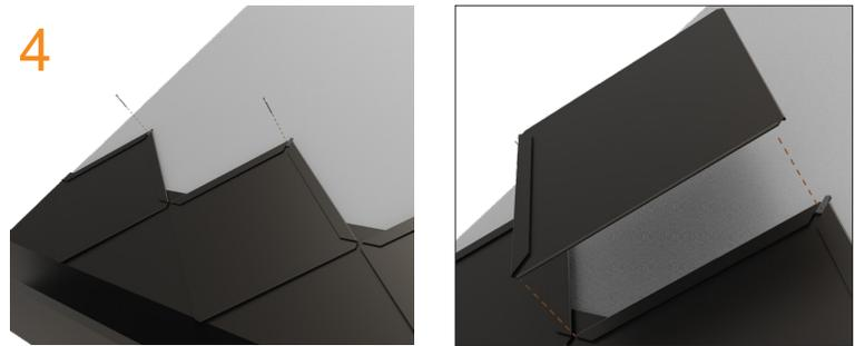
En paralelo al montaje de los módulos, a cada uno se van insertando las trabas mecánicas para fijarlo a la estructura, se recomienda clavo zincado de 1" en conjunto con el sello de PVC para proteger de daños el producto.
