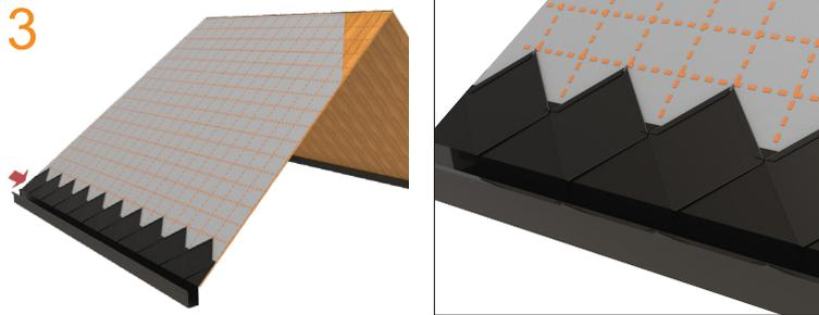
Luego se comienzan a montar los módulos desde abajo hacia arriba, dejando la unión a la siguiente hilera y el punto de fijación a la base ambos en la parte superior del módulo. Siendo trabados como primera parte del montaje.
