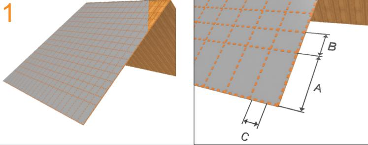
El trazado de la grilla debe ser iniciada desde la parte inferior de la cubierta, dejando un margen de 200mm mín. para un forro de base y luego comenzar desde el inicio con una medida de 200mm (A) en la primera fila y 135mm (B) en las subsiguientes y en avance horizontal 158mm (C) hasta completar el área a cubrir por el producto.
